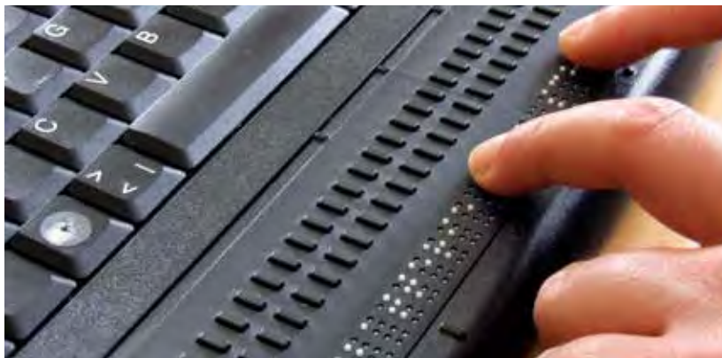
Tastatur mit tastfähiger Brailleschrift zur Wiedergabe digitaler Texte bei Sehbehinderung
